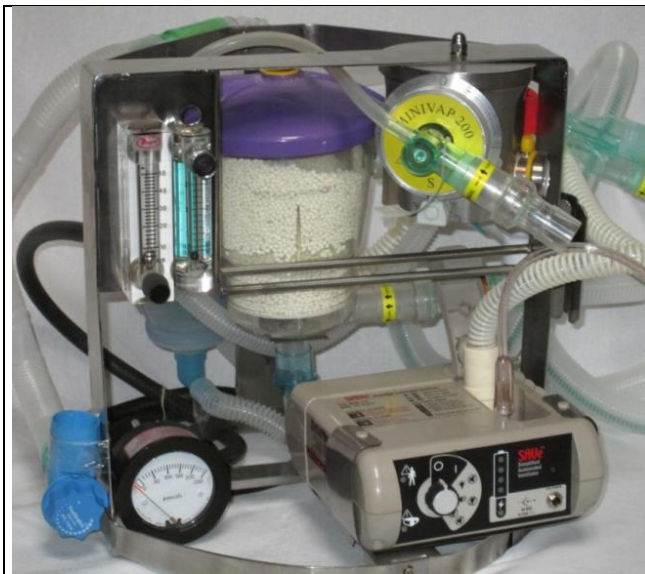
Рис. 27. SAVe + «Колибри» п/з контур 22 мм (испаритель МИНИВАП/S и абсорбер «Intersurgical»)
