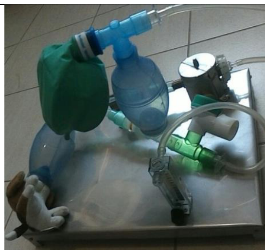
б – реверсивный контур VIC с мешком Амбу в виде маски, ротаметром для O 2 и абсорбером (вертикальный Амбу)
