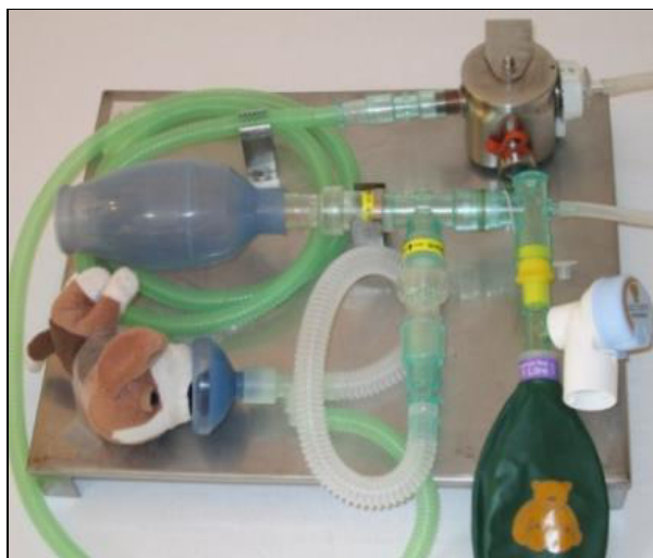
а – реверсивный контур VIC с мешком Амбу 300 мл для подачи воздуха и обратными клапанами вдоха и выдоха
