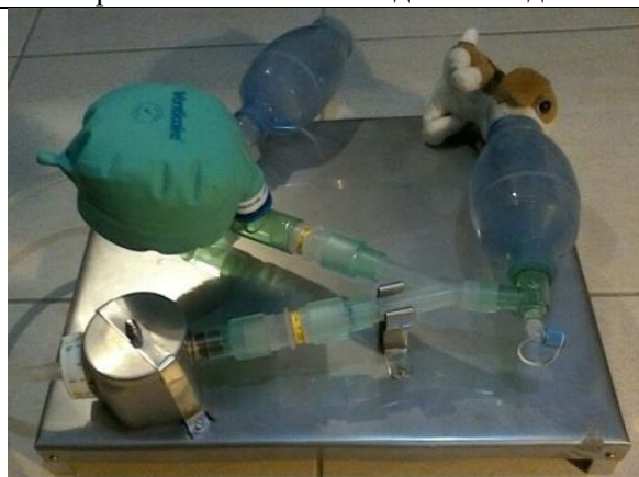
в – реверсивный контур VIC с мешком Амбу в виде маски и 2-м Амбу для подачи воздуха
